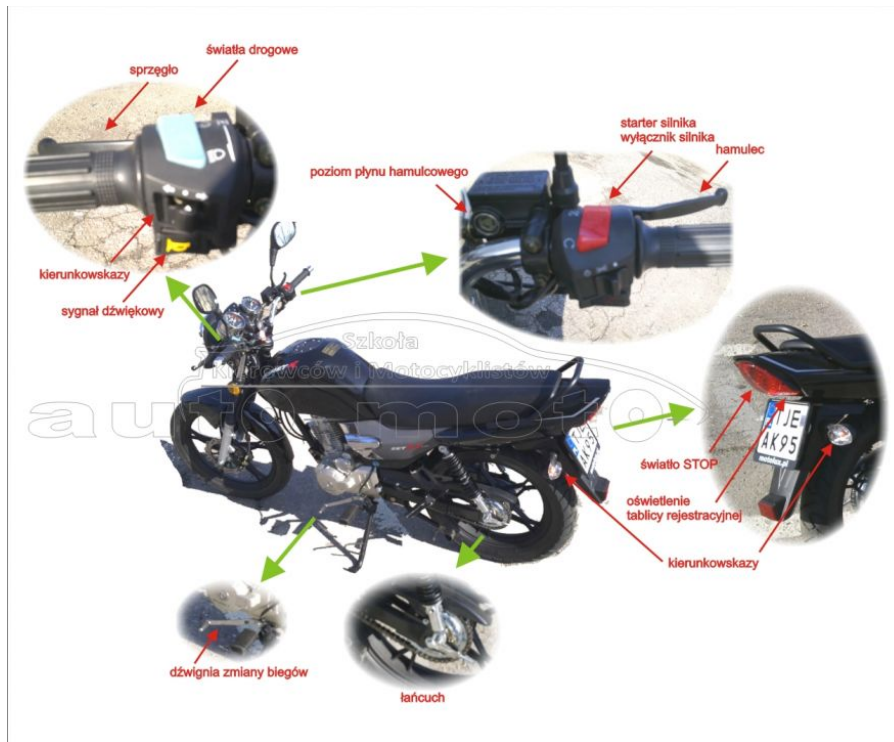
Romet ZETKA 125 - czynności kontrolno-obługowe na placu manewrowym (kliknij na obrazek, aby powiększyć)
